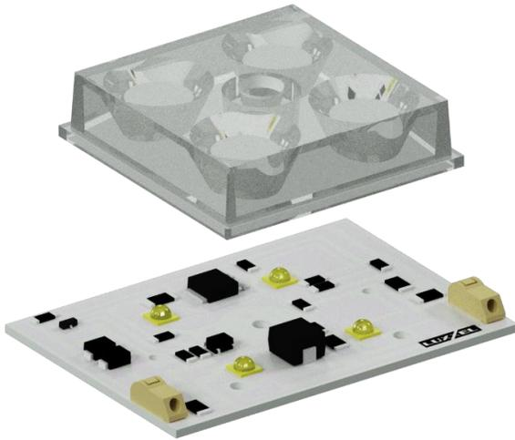
Módulo LED 24VAC/DC para aplicação em luminárias de galpões, projetores, postes, etc.
